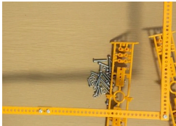
(5) れんけつ 連結したアームの右端の あな 穴に アーム部品を取り付ける (長さ1cmのネジと、ナットを使う)
