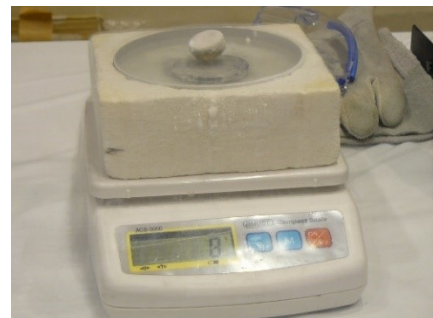
図8 反発力を測定する秤を組み合わせた例
