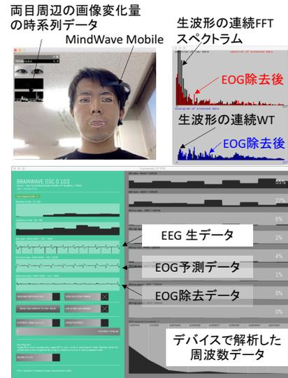
図2 脳波計測・解析システムの実行画面. カメラ画像による瞬き検出, EOG データの検出・除去・記録, フィルタ, FFT・WT による周波数解析を行う.
