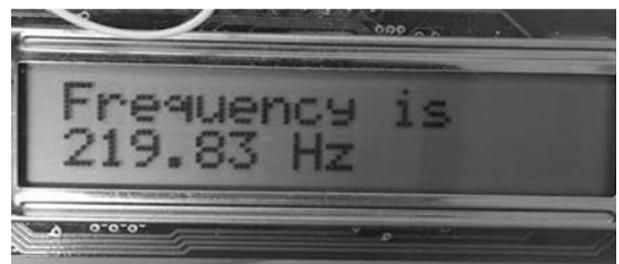
図3. LCDへの周波数表示例
