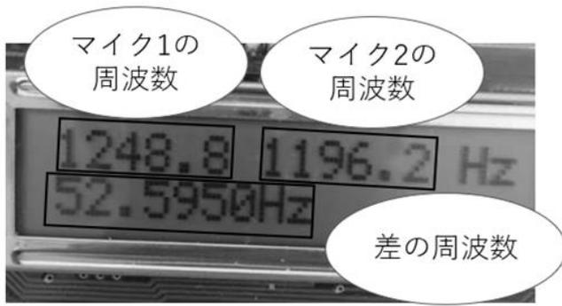
図 8. LCD への周波数表示例
