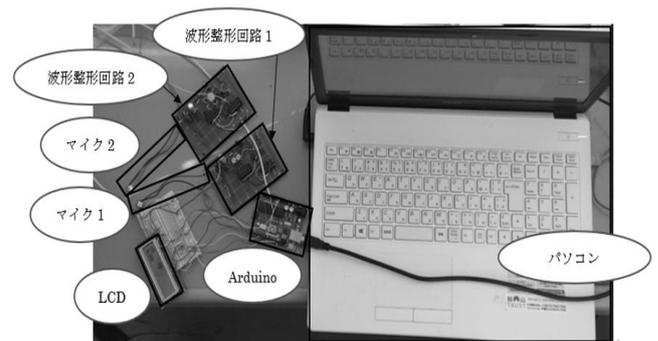
図 7. 実際に作製した回路
