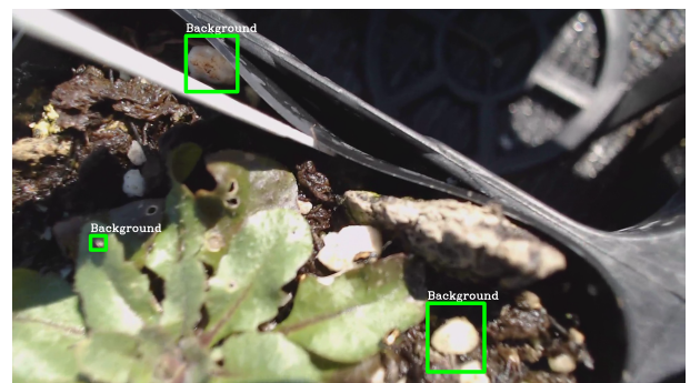
図 8: YOLO の過検出を Xception で訂正できた例 (左: 動画の 216 フレーム目を YOLOv3 で検出・識別した結果, 右: YOLOv3 が出力した矩形領域を Xception で再識別した結果)
