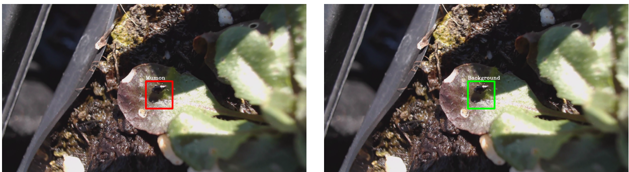
図 15: YOLOv3 が正しく識別した領域を Xception で誤識別した例 (左: 動画の 423 フレーム目を YOLOv3 で検出・識別した結果, 右: YOLOv3 が出力した矩形領域を Xception で再識別した結果)
